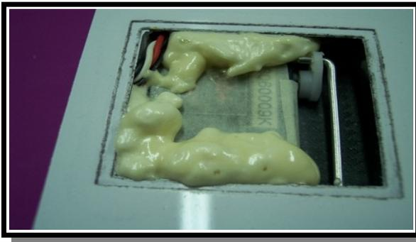
Zum tauschen eines Servos wird dann der Schaum rund um den Servo mit einem Balsamesser eingeschnitten und der Servo mit einer Zange herausgeholt. Dabei löst sich das Krepp vom Servo und die harte Epoxyschicht mit der Kante des Balsamessers wegschaben. Neuen Servo wieder frisch einpacken und einkleben. Dauert höchstens 30 Min., zu Hause kann man dann nachschäumen wenn notwendig.
